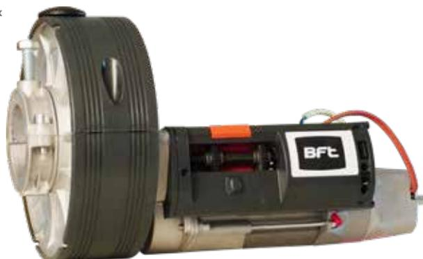
Operatori 230V per serrande avvolgibili con coppia massima fino a 445 Nm. Adatti al montaggio su serrande con puleggia dal diametro di 200, 220, 240 e 280 mm ed albero con diametro 42, 48, 60, 76 e 101 mm. Disponibili nelle versioni con e senza elettrofreno.
