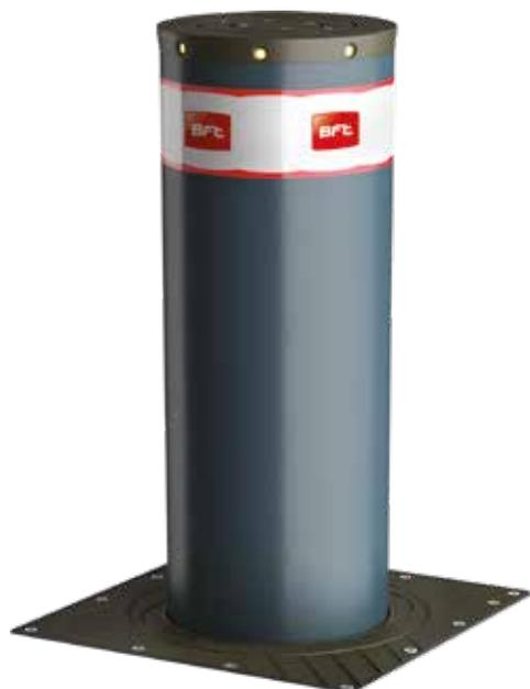
Dissuasore automatico oleodinamico ad alta resistenza con centrale oleodinamica incorporata, testato e certificato da organismo indipendente in conformità a PAS68:2010 con rating 7500/50/N2 che include ASTM F2656:2007 M30 (simulazione dinamica). Versione SD che mantiene lo stelo sollevato in assenza di corrente (salvaguardia di siti sensibili). Versione standard in cui lo stelo scende spontaneamente in assenza di corrente.
