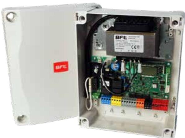
Quadro di comando a display per uno o due operatori elettromeccanici 24V utilizzato nei cancelli a battente da 230V/500W (nella versione Power). La ricevente radio bi-canale è incorporata. Dispone di un sistema anti-schiacciamento basato sulla tecnologia D-Track, gestisce il rallentamento in apertura e chiusura e dispone di una funzione di autoapprendimento elettronico. Tra le funzioni principali abbiamo la richiusura automatica, chiusura rapida, apertura parziale, funzionamento a uomo presente.
