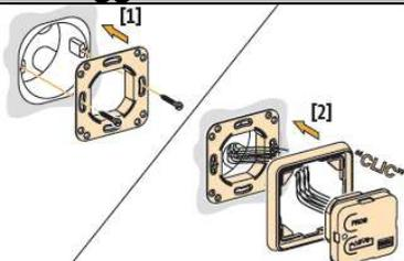
Fissaggio del ricevitore.
