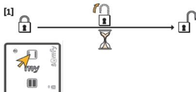
[1] Premendo il pulsante "APERTURA" si attiva l'output 1, il motore della serratura si sblocca, la porta può essere aperta. Chiudendo la porta, essa è serrata.
