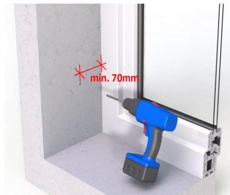
**2.2.3** Premontare le viti di fissaggio senza avvitarle completamente per poter successivamente installare la guida (max 4mm dalla testa della vite al primo spessore).
